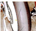
決勝走行後のカットスリッソフ。激しい走行に磨耗しきって溝がほとんど残っていない。
