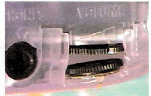
Schalter oder, wie hier, einen Dimmer installiert Ihr unter dem Lautstärkereglern.
