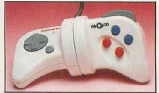
Der Ne-G-Con läßt sich in der Mitte um bis zu 135 Grad drehen
