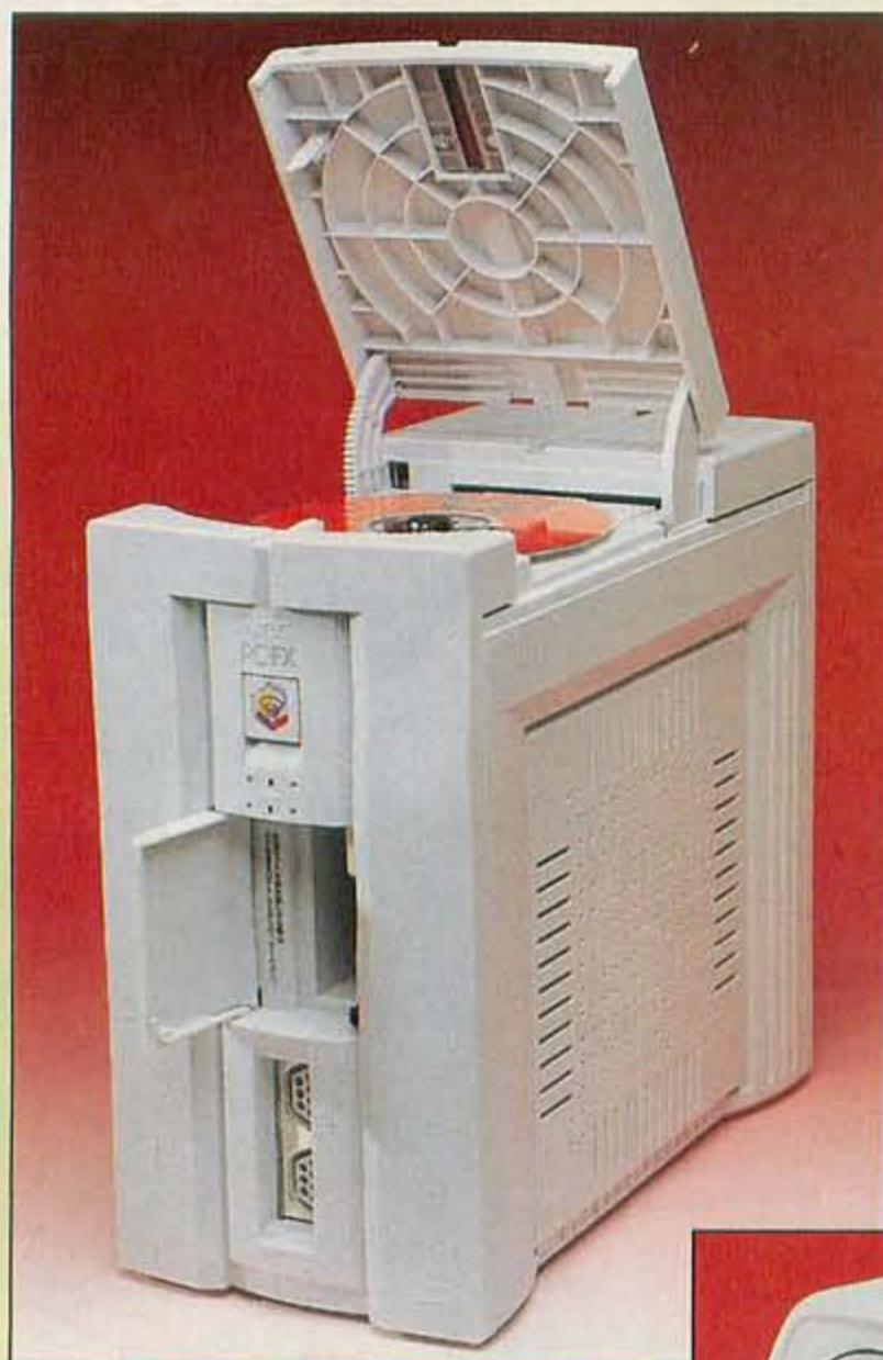
Die PC-FX ist ein Toploader mit einem Double-Spin CD-ROM-Laufwerk. Dazu gibt's einen 6-Button-Joyypad.
