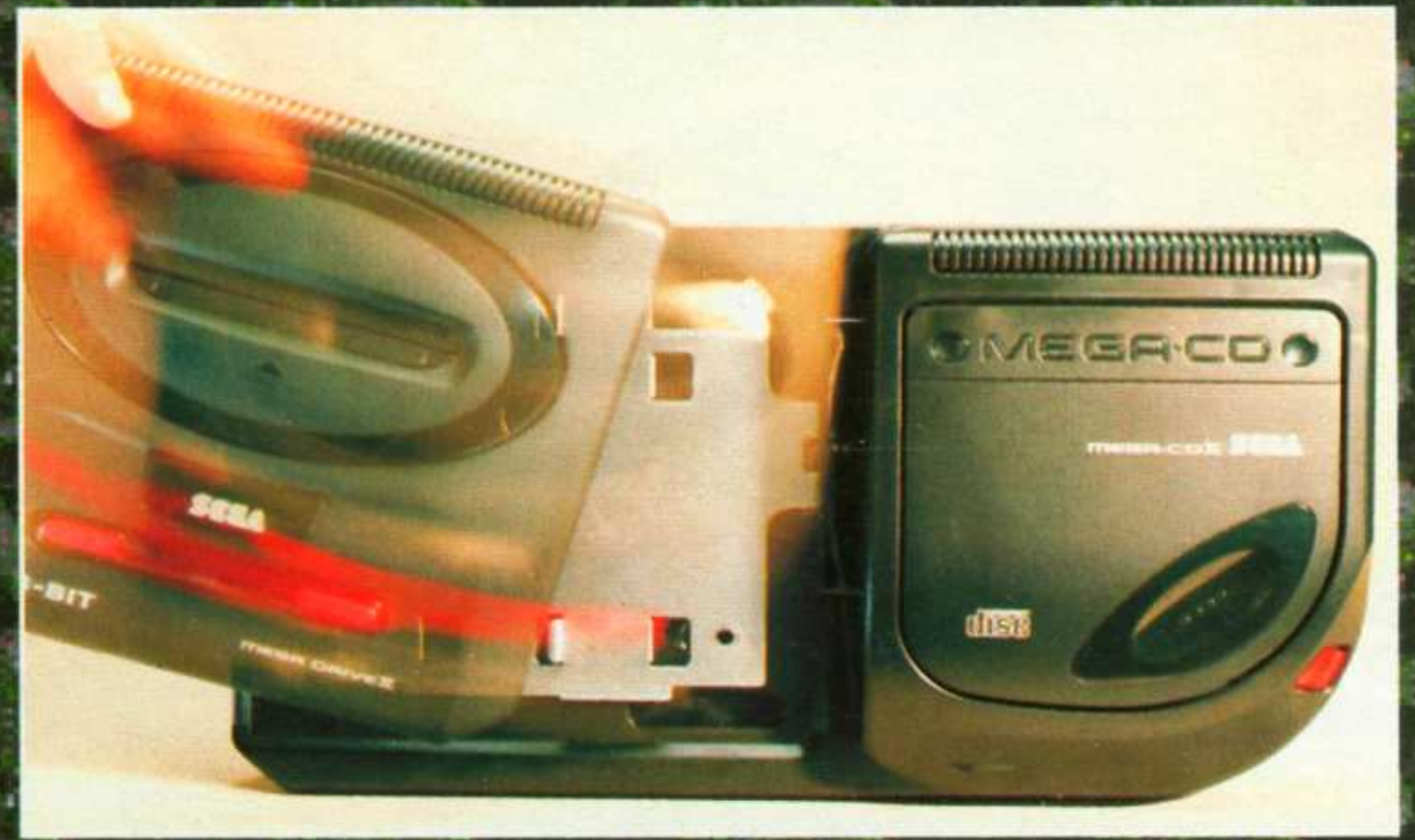
Aus eins mach zwei! Der Mega Drive kann seitlich abgezogen werden. Übrig bleibt dann nur das CD-ROM-Laufwerk
