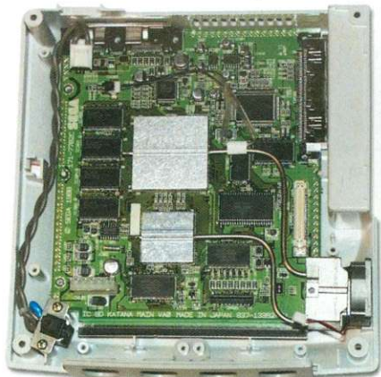
Schritt 3: Nach dem Öffnen der Konsole entfernt Ihr mit dem Schraubenzieher Netzteil-, Joypad- und CD-Laufwerk-Komponenten, sowie das Schutzblech darunter.
