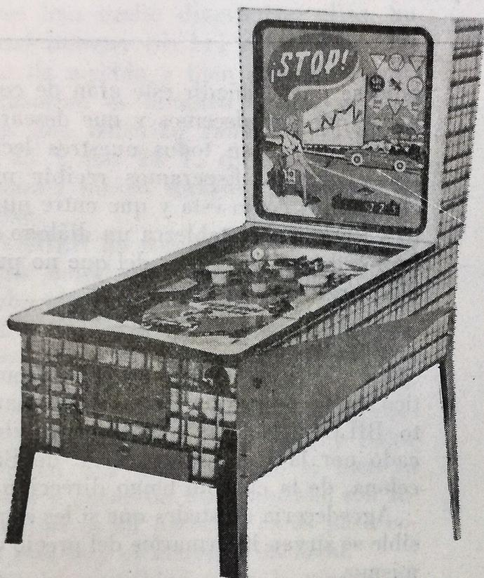
STOP, de Automáticos Vaher. Sus principales características las constituyen los dos flippers, dos bandas automáticas, cuatro bumpers, un cañón automático, tablero de juego vitrificado y el mueble en formica o railite.
