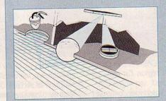
La souris optique de VisiCorp: une source lumineuse éclaire une plaque quadrillée de lignes bleues (sens horizontal) et rouges (sens vertical). Les cellules de détection enreqistrent le passage de chaque ligne. Le
