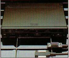
L'arrière de l'appareil comporte, à droite, le connecteur GPIB (IEEE 488) qui permet de chaîner lecteur de disquettes et autres périphériques.
