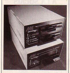
français de disques durs propose un lecteur compatible Apple II capable de stocker 1 Mo de données sur une disquette de 5 1/4 pouces formatée: 7 fois plus sur le même support. Le G 501 de Micro-Expansion fonctionne sous les systèmes d'exploitation DOS 3.3, CP/M, Pascal UCSD
