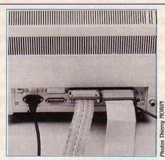
De gauche à droite, le câble d'alimentation, la sortie imprimante parallèle, la prise du disque Winchester, la prise du coffret disquette.
