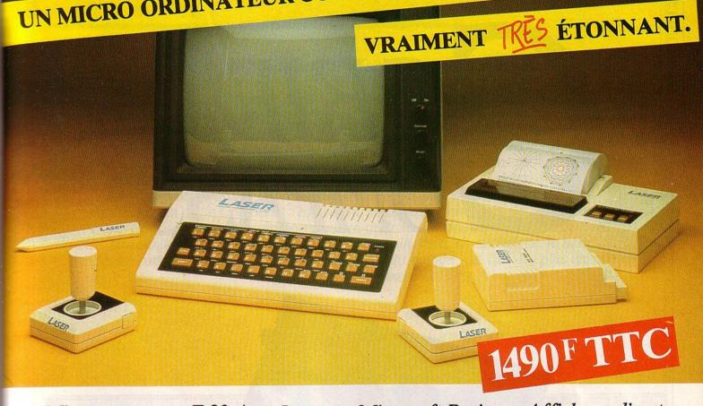
Microprocesseur Z 80 A • Langage Microsoft Basic • Affichage direct antenne télé SECAM • Clavier 45 touches pleine écriture, + clef d'entrée, + graphismes, + bip sonore anti-erreurs... • Texte + graphismes mixables
