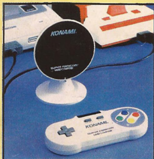
Hyperbeam usa un receptor de forma parabólica.
