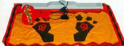
▲ So sieht das Dings aus: Mittels Sensoren wird die Position der Rasseln gemessen.
