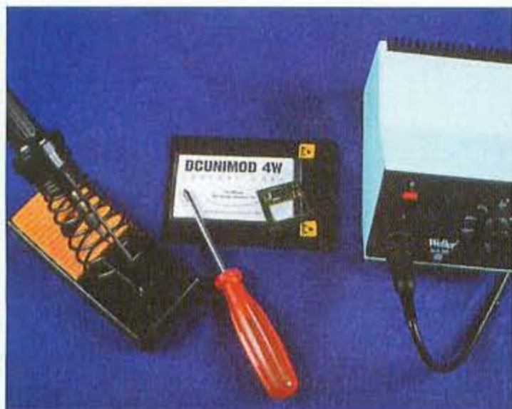
▲ Das benötigte Werkzeug: Lötcolben (nicht mehr als 300 Grad, feine Lötspitze), Lötzinn (1mm Durchmesser oder weniger) und ein Kreuzschlitzschraubenzieher. Bevor ihr loslegt: Netzstecker ziehen!!!
