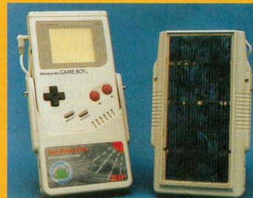
licht über das Solar-Panel (Ladezeit laut Hersteller 5 bis 6 Stunden) oder bei schlechtem Wetter via Netzanschluß (nur 3 Stunden) speisen.
