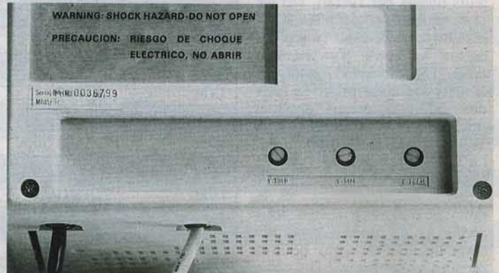
A l'image de l'écran Atari PCM 124, le MM 211 d'AOC offre une face arrière fort dépouillée mais l'on peut malgré tout régler le centrage de l'image.
