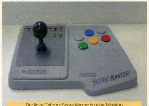
Der linke Teil des Score Master ist eine Miniaturausführung des Super-Nintendo-Grundgeräts. Leider ist der Stick nicht mit Mikroschaltern bestückt.
