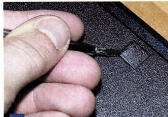
PS2 Die Gehäuseschrauben findet Ihr unter den Platten an der Unterseite.
