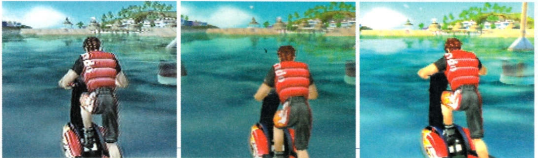
Drei RGB-Kabel im Vergleich: Das Speedlink-Produkt liefert ein mieses Bild (links). Das offizielle Zubehör von Nintendo (Mitte) überzeugt mit scharfer und klarer Optik. Beim Booster-Kabel (rechts) leuchten die Farben.
