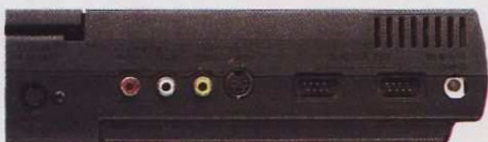
Entradas e saídas para vídeo, áudio e controles. Ponto para a saída de Super VHS
