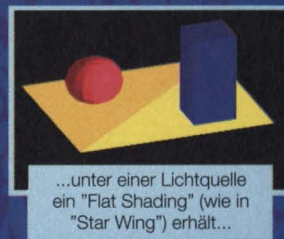
Rendering: Aus dem 3D-Modell wird ein massives Objekt errechnet, das....
