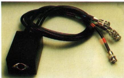
Il cavo autocostruito per collegare il monitor al BBC con cui sono state realizzate le immagini presentate.
