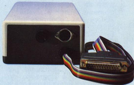
Il cavo di collegamento alla porta RS 232, il fusibile e la presa Din di alimentazione.
