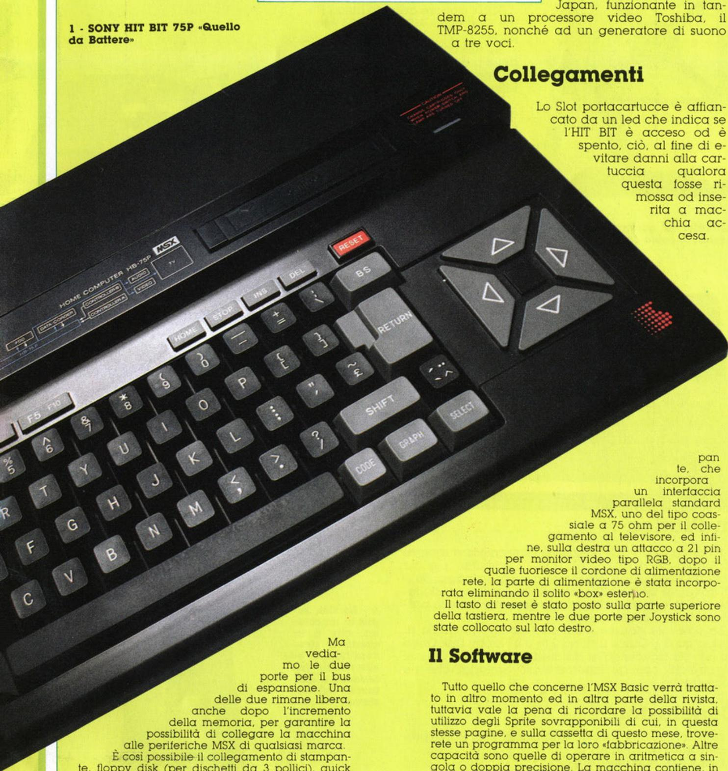
Ma vediamo le due porte per il bus di espansione. Una delle due rimane libera, anche dopo l'incremento della memoria, per garantire la possibilità di collegare la macchina alle periferiche MSX di qualsiasi marca. È così possibile il collegamento di stampante, floppy disk (per dischetti da 3 pollici), quick disk (per dischetti da 2,8 pollici), modem, ecc. Sul retro del mobile sono presenti altri 5 connettori, due del tipo din per registratore a cassetta e monitor audio-video, uno per stam-
