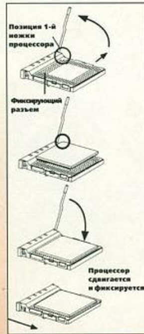
Установка процессора в ZIF-разъем.
