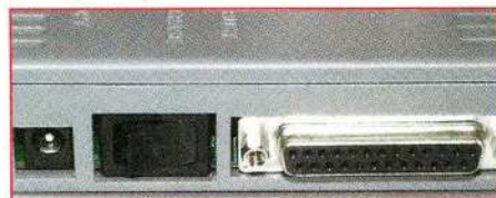
Seitenansicht: Rechts befindet sich die Parallelschnittstelle, links die Netzteilbuchse und in der Mitte der Hauptschalter.
