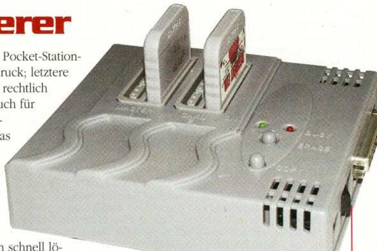
X-Drive in Aktion: Das Memory-Card-Original steckt Ihr in den "Master"-Slot, die zukünftige Kopie in den "Card 2"-Schacht.
