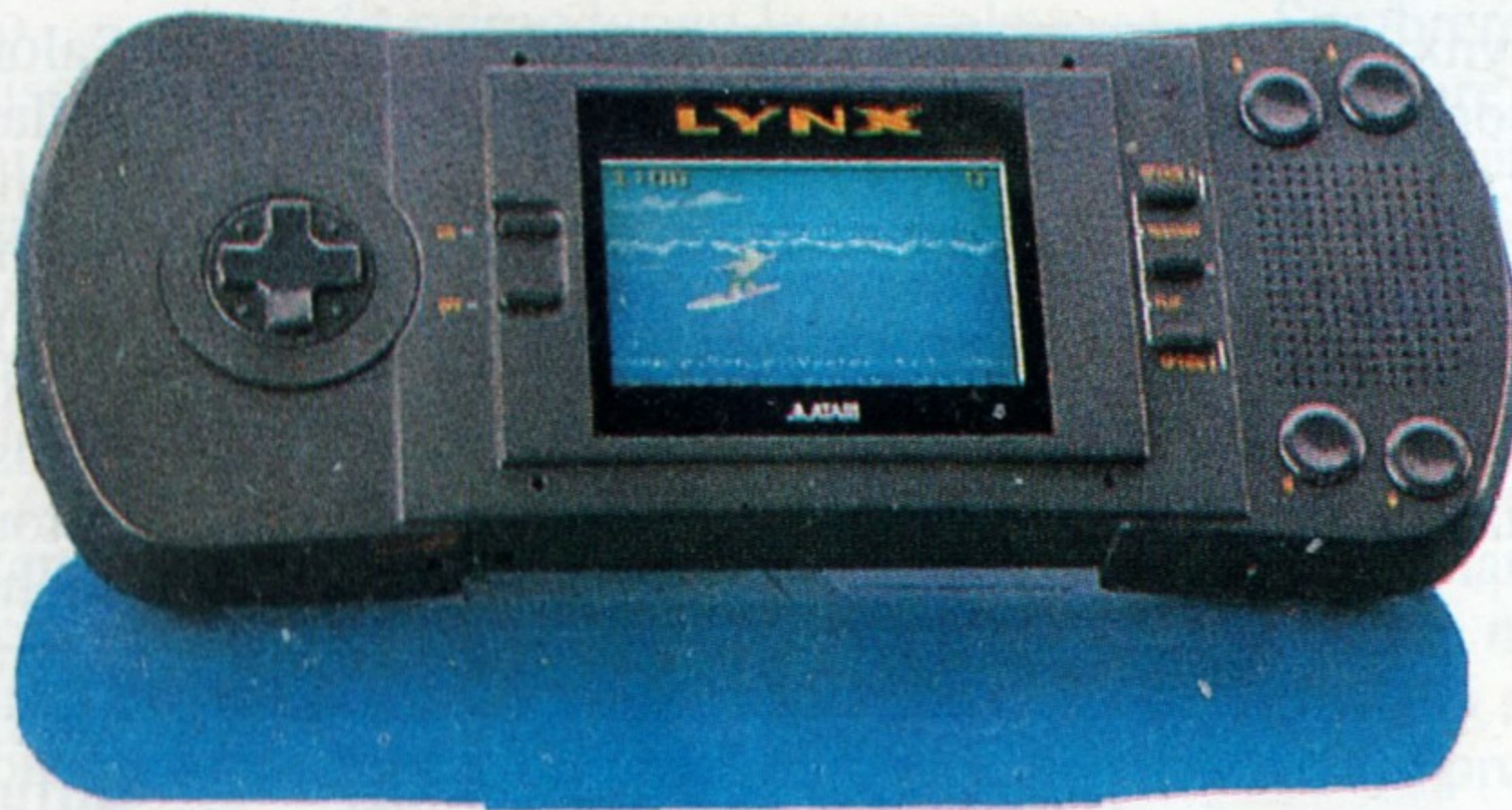
La console portatile Lynx con schermo a colori a cristalli liquidi
