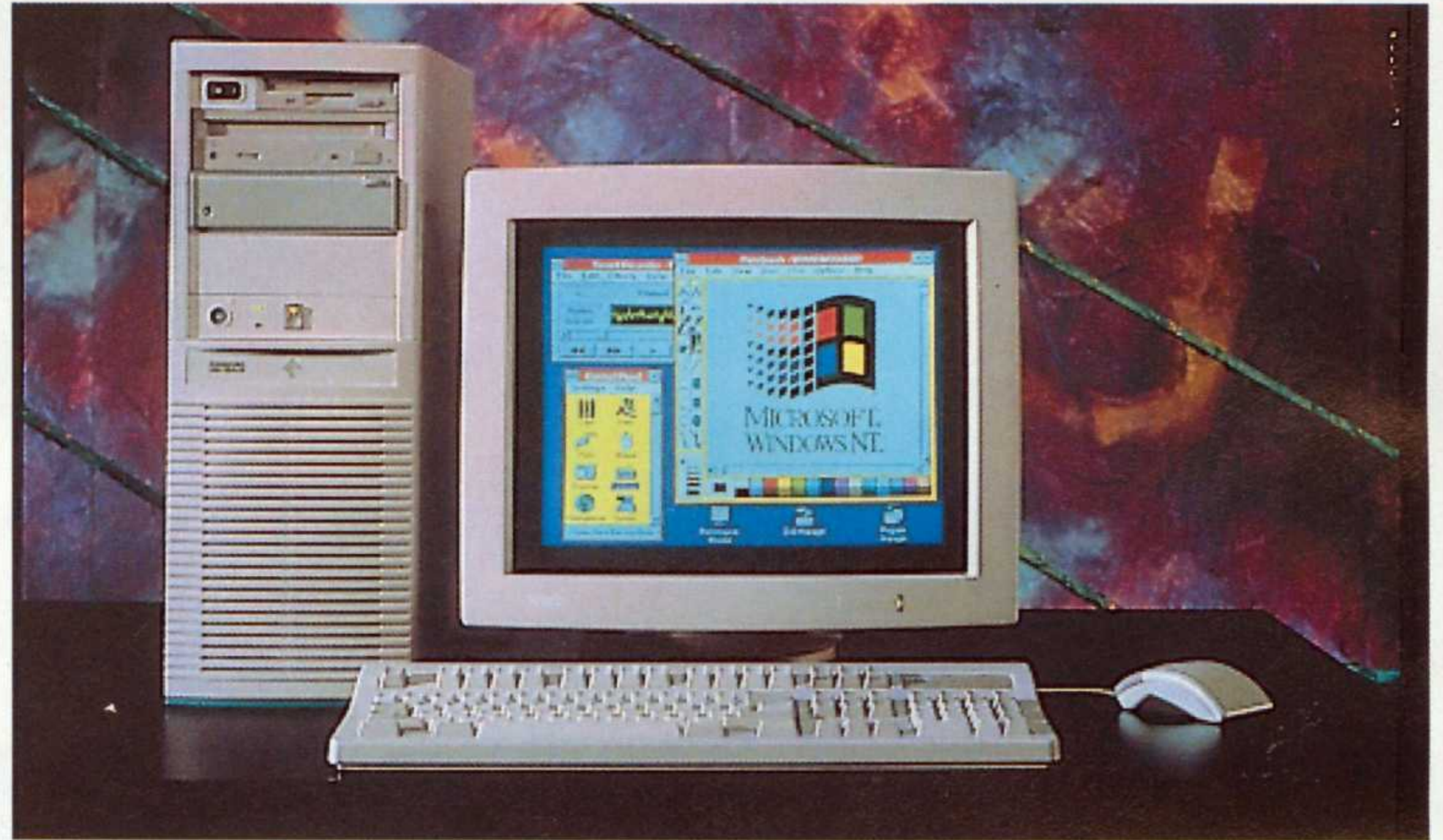
Der DEC Alpha AXP ist streng genommen kein richtiger PC, aber man kann Windows NT und andere Windows-Anwendungen darauf laufen lassen. Er nutzt einen sehr schnellen 66 MHz RISC-Prozessor, ist jedoch sehr teuer.
