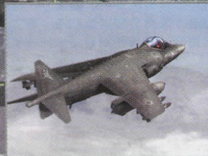
AV-8B Harrier II 全長：14.55m/全幅9.25m/ 最高速度0.98Mach
