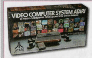
◆(圖3) ATARI VIDEO COMPUTER SYSTEM - CX 2600 (1977) 中央處理器：8bit Motorola 6507 記憶體：128 Bytes 卡帶容量：最大4KB 處理器時脈：1.19 MHz
