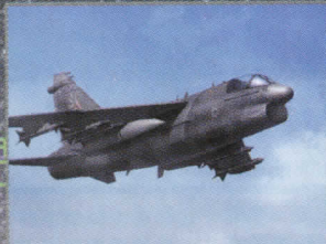
A-7 Corsair II 全長：14m/全幅11.8m/ 最高速度0.9Mach
