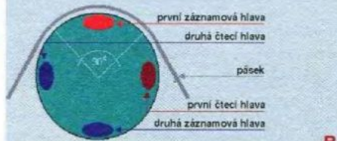
► Způsob uložení stop na magnetické pásky: A. serpentinový (QIC), B. šikmý (DAT)
