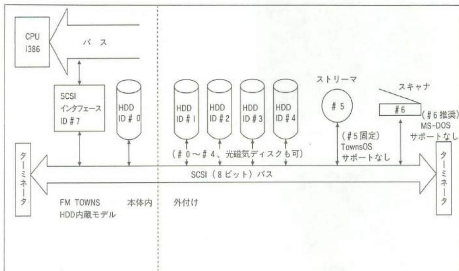
Fig.2-5B SCSIバス(母線)につながるID#0~6のSCSI機器とID#7本体、両端のターミネータ
