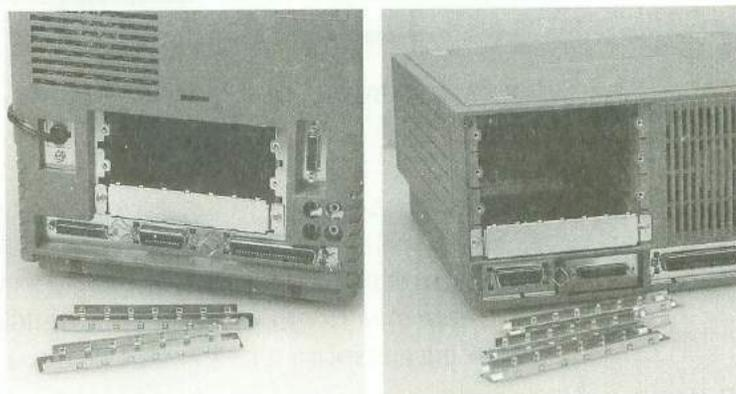
Ph1.1-3 左はUG系の本体背面。汎用バススロットが2に。右はHG/HR系の本体背面。スロットは3に増えている
