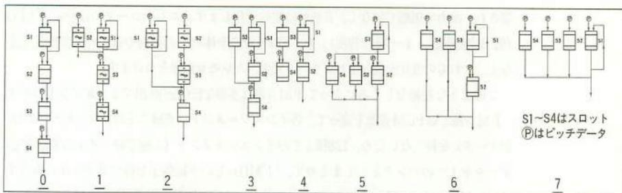
Fig.1-50 スロットの連結パターン (8通り)
