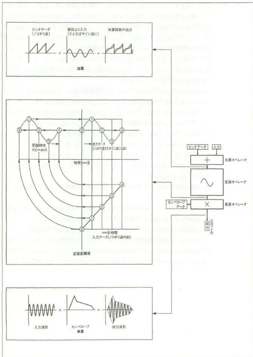
Fig.1-49 スロットの機能 (3つのオペレータ)
