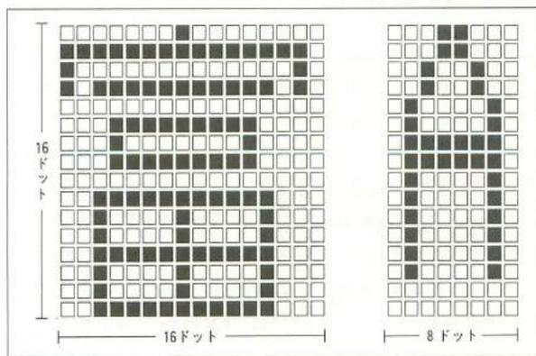
Fig1-4 ドットマトリクス表示の例
