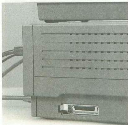
Ph1.1-4 HG/HR系の本体左側面。増設フロッピーディスク用コネクタがこの位置になっている
