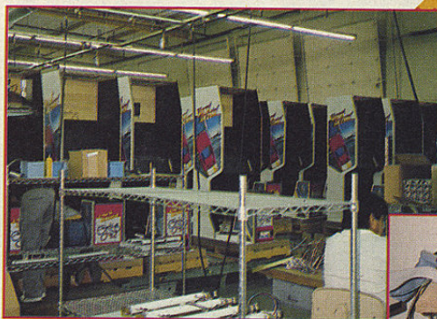
◀ Ein Hard-Drivin-Gehäuse senkrecht — nur so kann man alles einbauen
