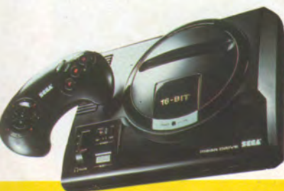
MEGA DRIVE. Το Video game που ξεπερνάει κάθε προηγούμενο. Η τεχνολογία των 16 BIT στην υπηρεσία της ψυχαγωγίας με κύριο επεξεργαστή 68.000 και επεξεργαστή Z 80. Στερεοφωνικός ήχος 10 καναλιών.
