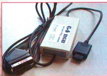
Notlösung für Fernseher ohne S-Video-Eingang: Das neue Kabel von GT wandelt das S-Video- in ein RGB-Signal.
