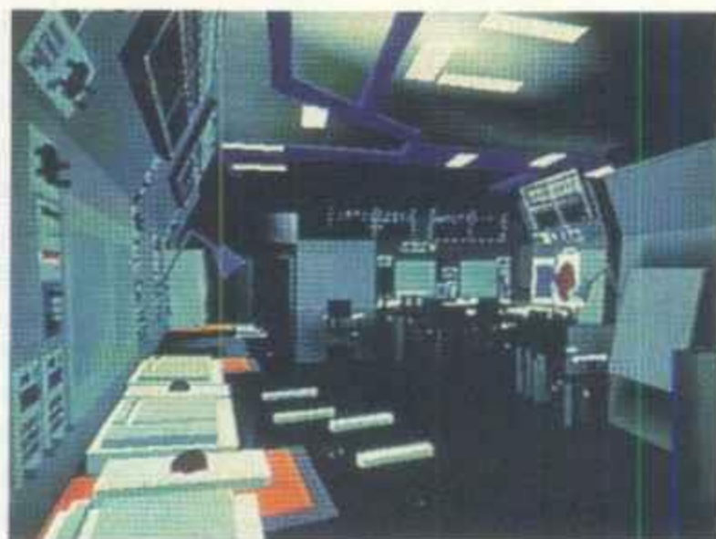
Navidezna resnični model rušilca Marlborough, kjer lahko posadka ugotavlja ergonomičnost in pripravnost aparatur, še preden je ladja v vodi.
