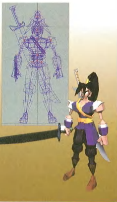
▲這便是Skeleton技術設計出的角色，wire內的紅點是根據骨骼設定而成的部份右手邊是製作完成的角色。
