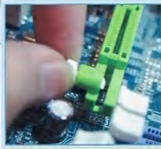
EZ-fix AGP 插槽讓顯示卡更容易安裝和固定以避免損壞。
