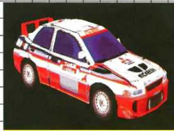
Mitsubishi Lancer Ev.IV WRC Allradantrieb, 2,0-Liter-Turbolader Max. Leistung: 300 PS bei 6000 U/min Max. Drehmoment: 45 kg/m bei 4000 U/min Gewicht: 1280 kg
