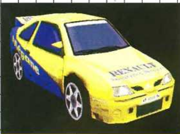
Renault Max Mégane Frontantrieb, 2,0-Liter-Saugmotor Max. Leistung: 270 PS bei 8000 U/min Max. Drehmoment: 26 kg/m bei 6000 U/min Gewicht: 960 kg
