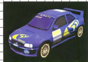
Subaru Impreza 555 WRC Allradantrieb, 2,0-Liter-Turbolader Max. Leistung: 300 PS bei 5500 U/min Max. Drehmoment: 45 kg/m bei 4000 U/min Gewicht: 1300 kg
