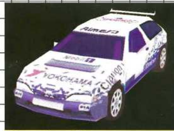
Nissan Almera Kit-Car Frontantrieb, 2,0-Liter-Saugmotor Max. Leistung: 265 PS bei 8000 U/min Max. Drehmoment: 26 kg/m bei 6000 U/min Gewicht: 960 kg
