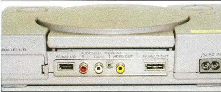
Anwenderfreundlich: Einige ältere PlayStation-Baureihen bieten komfortable Cinch-Ausgänge für getrennte Audio- und Videosignale (rot, weiß, gelb)
