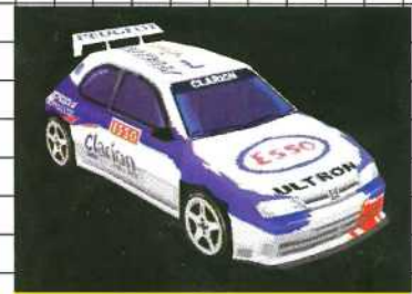
Peugeot 306 Maxi Frontantrieb, 2,0-Liter-Saugmotor Max. Leistung: 275 PS bei 8800 U/min Max. Drehmoment: 26 kg/m bei 6500 U/min Gewicht: 960 kg
