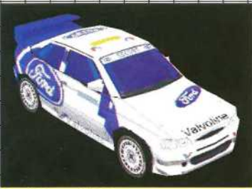
Ford Escort WRC Allradantrieb, 2,0-Liter-Turbolader Max. Leistung: 300 PS bei 6250 U/min Max. Drehmoment: 41 kg/m bei 5000 U/min Gewicht: 1230 kg
