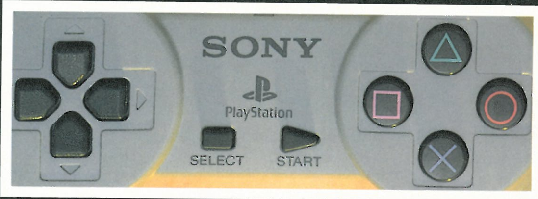
Hemos seleccionado este plano del pad para que veáis el enorme parecido de diseño que existe con el de Súper Nintendo, con cuatro botones (a los que se han cambiado las letras A,B, X e Y por figuras geométricas), y un control direccionador dispuesto como si se tratara de cuatro pulsadores distintos. Los botones L y R, que también existen, se han visto duplicados para albergar más funciones.
