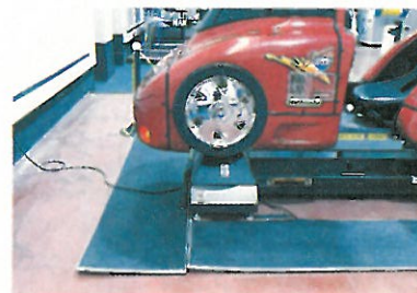
Un límite metálico bordea la dedicated machine. Si algo entra en contacto con él, parará el movimiento para evitar atropellos.
