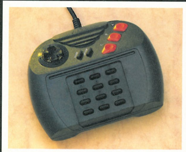
El control pad de Jaguar tiene 17 botones que pueden desempeñar distintas labores. El gran problema de los 12 botones inferiores, es que no pueden ser usados sin un poco de práctica.
