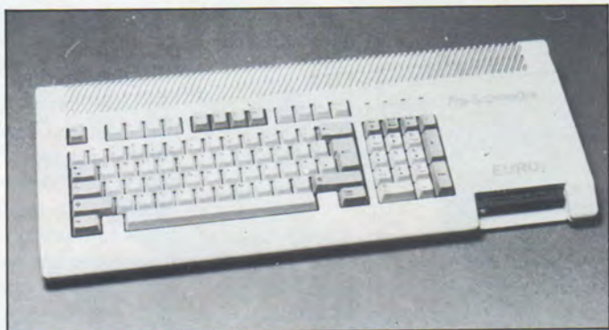
Τα δύο τρίτα του EURO PC: η κεντρική μονάδα με το πληκτρολόγιο. Το drive φαίνεται δεξιά.
