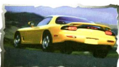
MAZDA RX-7 Wankel-Motor mit Twin-Turbo, 255 PS, 1308 ccm, 254 km/h, ABS
