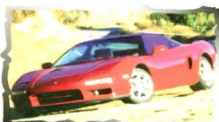
HONDA (ACURA) NSX 6 Zylinder, 270 PS, 2977 ccm, 270 km/h, ABS, Traktionskontrolle
