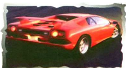
LAMBORGHINI DIABLO VT 12 Zylinder, 492 PS, 5707 ccm, 325 km/h, Vierradantrieb
