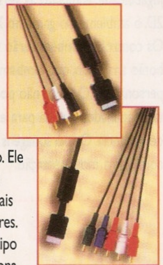
Cabos tipo S-Video (no alto) e componente
