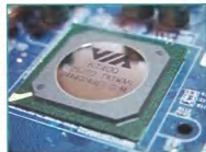
青雲 Albatron KX400-8XV Pro 北橋晶片採用了 82801n 的 BGA 封裝
