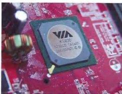
微星 MSI KT4V 北橋晶片採用了 82801n 的 BGA 封裝
