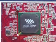
M 微星 MSI KT4V 採用 48701n GBA 封裝的 VT8235 南橋晶片
