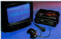
圖中是將麥克風接續到MIX端子上後，播放CDG卡拉OK。
