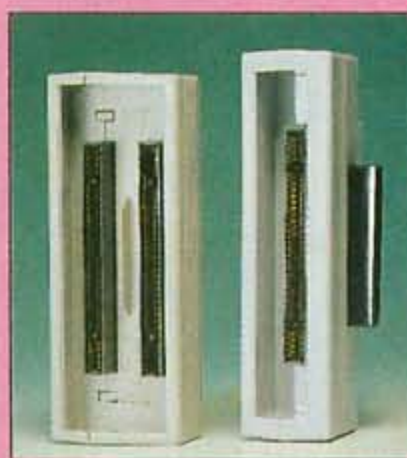
Beide Import-Adapter sind komplett durchgeschliffen
