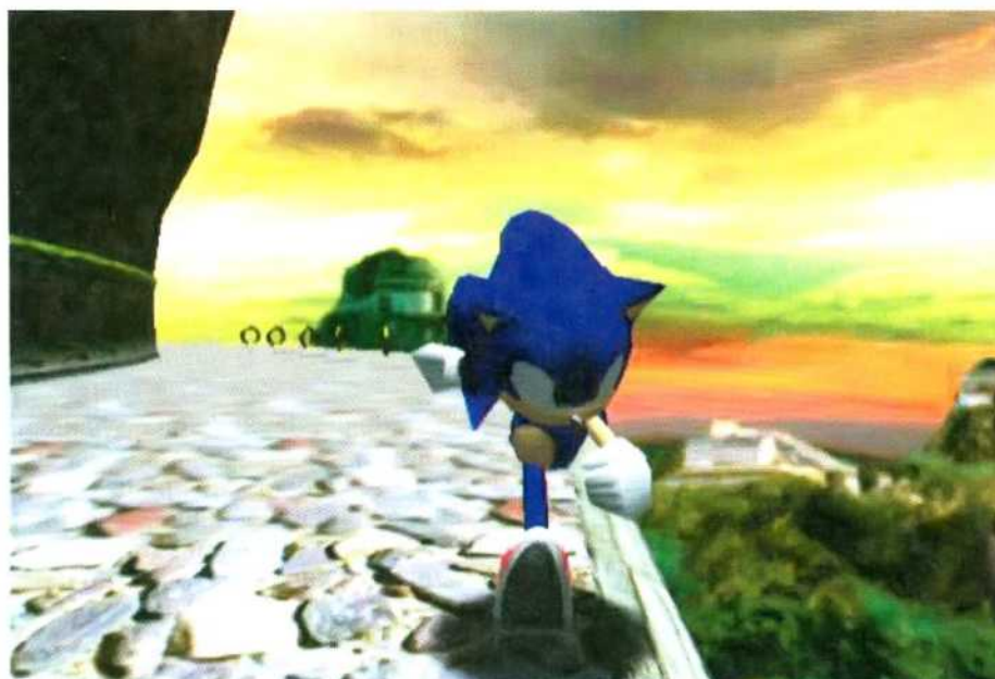
Das Mip Mapping in Action: Die Bodentextur wird im Hintergrund etwas unschärfer, um keine Rechenzeit zu verschwenden.
