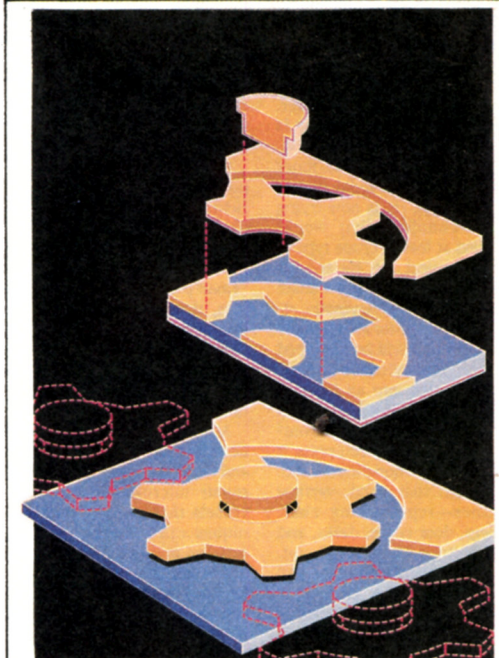
A — Napařování super-tenkých vrstviček B — Megačip odštipnutý z plátku na kterém leží C — Výroba mikročerpá- délka leptáním vrstviček A D B G E C F H
