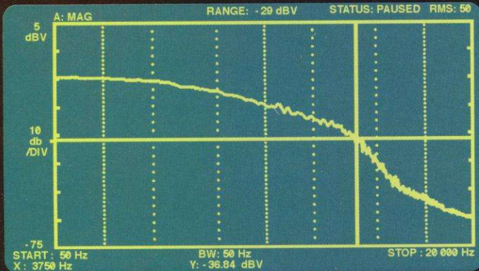
Herkömmliche Soundkarte: 13 kHz Sampling; fehlende Höhen, überhöhte Bässe
