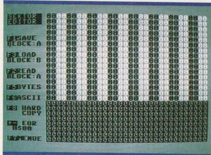
cherheitsgründen benutzt und ist wegen der Breite der Kopfspalte nicht anders machbar. Obwohl diese Zwischenspuren in der Regel teilweise den Inhalt einer Nachbarspur überschreiben, werden diese sehr oft zum Schützen einer Diskette verwendet. Aber auch diese Schutzverfahren machen DISKTOOL keine Probleme, da sich der Kopf auch auf solchen Halbspuren plazieren läßt. Allerdings sollte man hier sehr vorsichtig sein, denn so manche Diskette wurde schon durch Manipulationen unbrauchbar.
