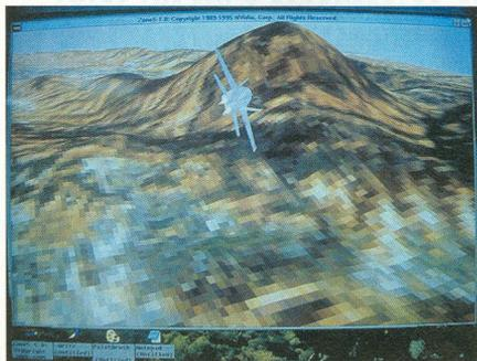
ERSTE MESSEDEMOS DES NV1-CHIPS VON NVIDIA ZEIGTEN REALISTISCHE, FLÜSSIGE FLUGSZENEN MIT 1024x768 PIXEL AUFLÖSUNG UND IN HI-COLOR AUF EINEM STANDARD-PC.
