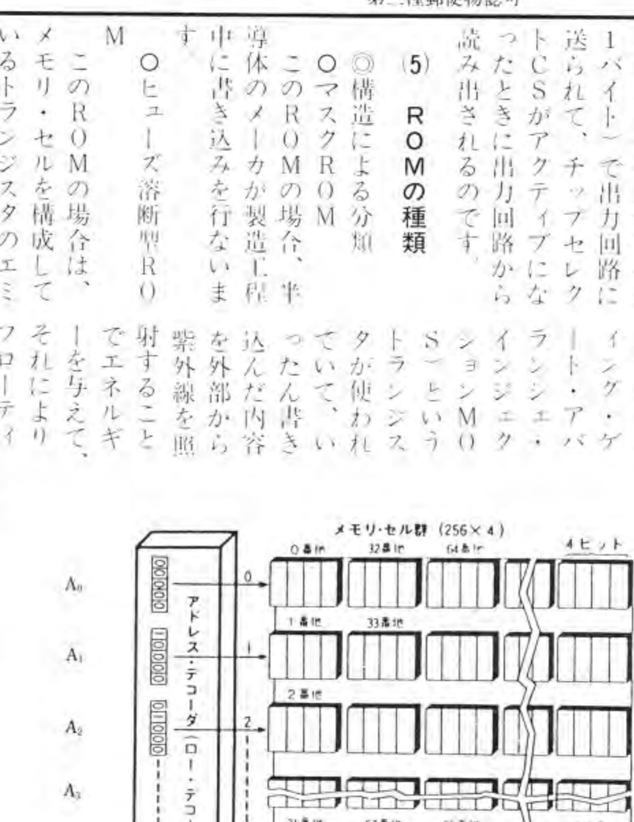
図6 256ワード(アドレス)×4ビット構成の1K RAMのブロック図
