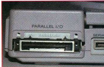
Für Sony überflüssig: Der "Parallel I/O"-Port fehlt bei der neuesten Hardware-Revision – angeblich aus Kostengründen.
