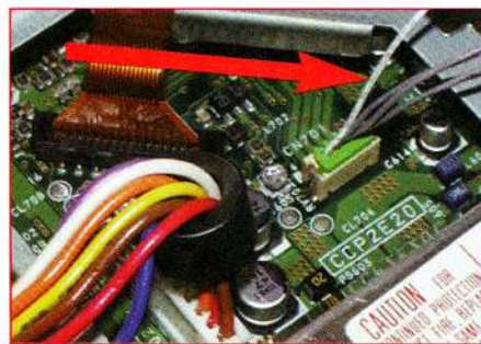
Der Motor-Stop: Öffnet Eure Playstation und sucht den Kabelstrang zwischen CD-Laufwerk und Hauptplatine (links, Pfeil). Durchtrennt das weiße Kabel (Mitte, Pfeil) und lötet das zweiadrige Kabel mit dem Kippschalter dazwischen (rechts).
