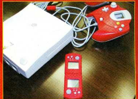
Während Sonys PDAs via Infrarot miteinander kommunizieren, werden Segas "Virtual Memory Systeme" ineinander gesteckt.
