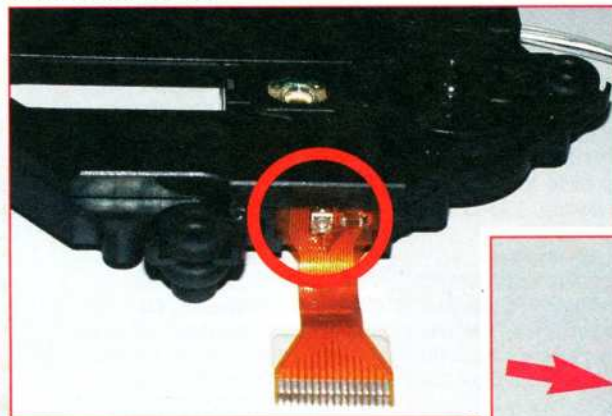
Am Flachbandkabel des CD-Laufwerks findet Ihr den Drehregler für die Stromversorgung des CD-Motors.
