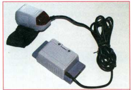
Gute Verbindung: Das Kabel zwischen Rumble-Armband und Joypadstecker ist etwa 1,5 Meter lang.
