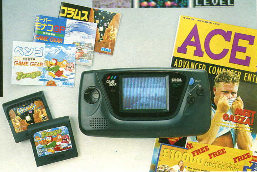
La console portatile a colori Game Gear della Sega... 4096 colori, quattro canali audio e sintonizzatore TV opzionale.
