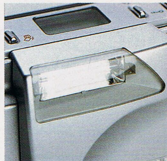
El flash de la cámara está integrado en la tapa de cierre de la Olympus.
