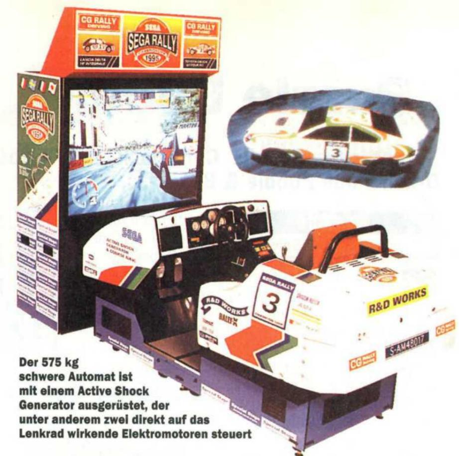
Der 575 kg schwere Automat ist mit einem Active Shock Generator ausgerüstet, der unter anderem zwei direkt auf das Lenkrad wirkende Elektromotoren steuert
