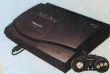
**Der Nachfolger FZ-10; als Top Loader konzipiert, voll kompatibel zum "alten" Modell, mit überarbeitetem Platinenlayout, integriertem Memory Manager, allerdings ohne Kopfhörerausgang; deutlich kostengünstiger in der Fertigung**
